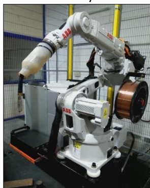
IRB 1520 MIG Welding Robot
